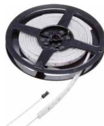
**F**LEXYLED SE H4 je linearna, fleksibilna LED traka s bočnom projekcijom (Side-Emitting). Razvijena novom tehnikom ekstruzije silikonskih materijala FLEXYLED SE H4 je konstruirana posebno za ugradnju u ravnini s površinom, u utore malih širina od 4 mm i dubina 10 mm. Za instalaciju SE kolekcije nije potrebno ljepilo ili ljepljive trake. Mekani silikonski profil
