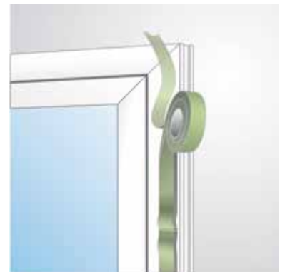
Slika 1: čono nastavljane trake kod montaže prozora
