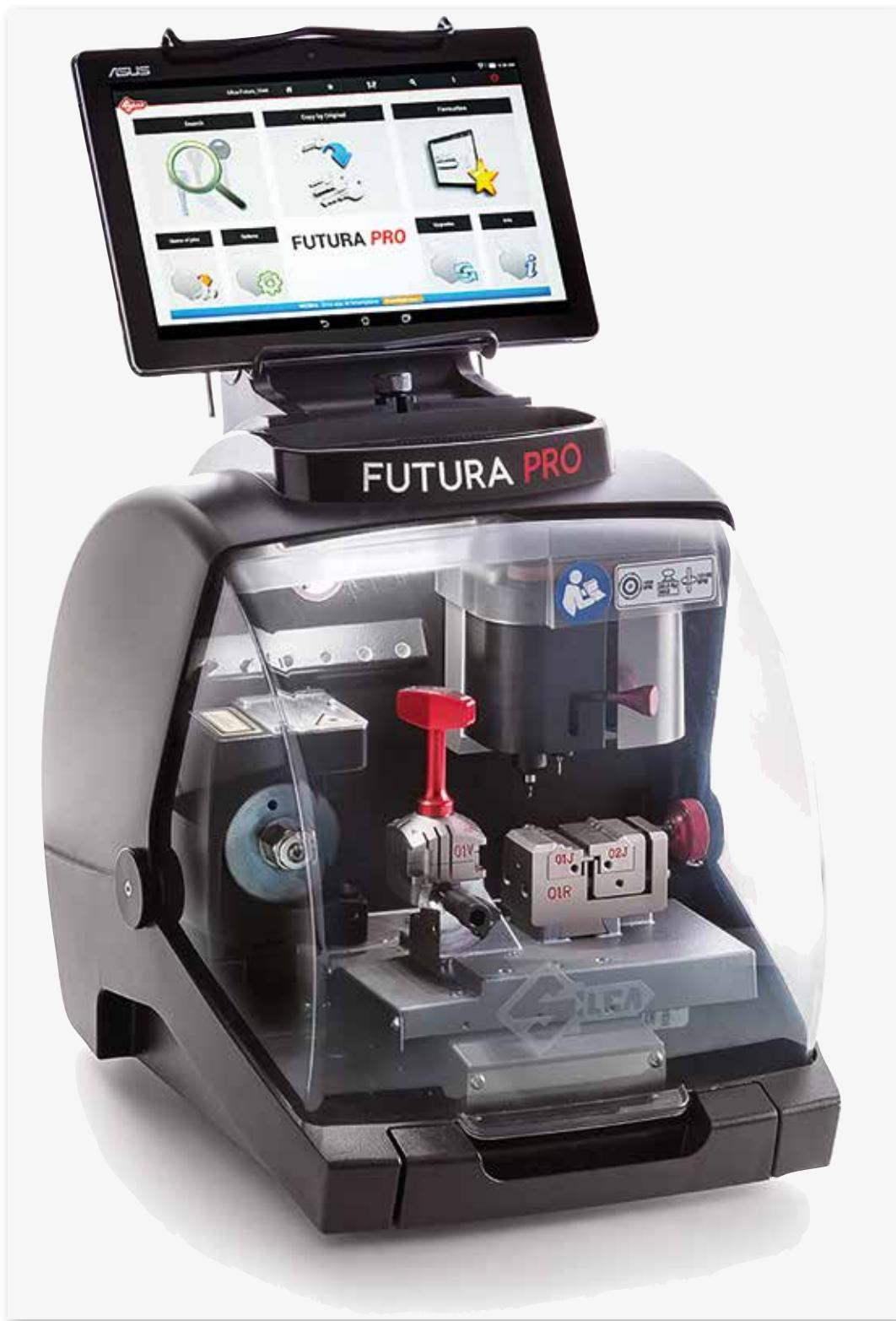
Silca Futura PRO stroj za izradu ključeva, graviranje ključeva i cilindara
