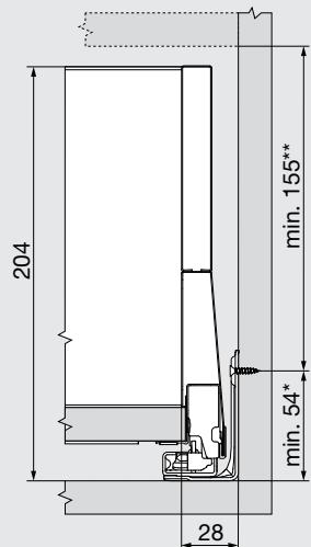
\* +1 mm kod montaže vodilice koja se pričvršćuje na korpus prije montaže
