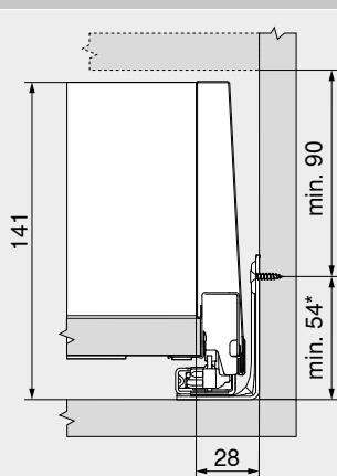
\* +1 mm kod montaže vodilice koja se pričvršćuje na korpus prije montaže
